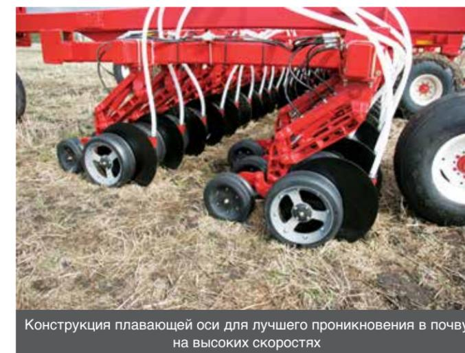
Конструкция плавающей оси для лучшего проникновения в почву на высоких скоростях
