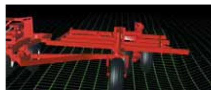
Дизайн плавающей рамы представляет секции независимого крыла.
