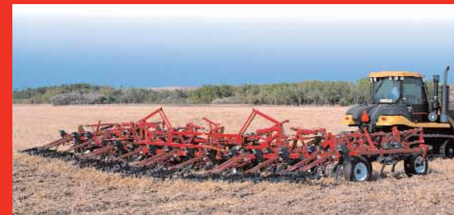
Опция навесная борона обеспечивает дополнительное выравнивание для финишной обработки поля.
