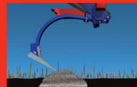
Уникальная характеристика угла наклона рабочего органа сокращает стресс на составляющих рабочего органа и рамы.
